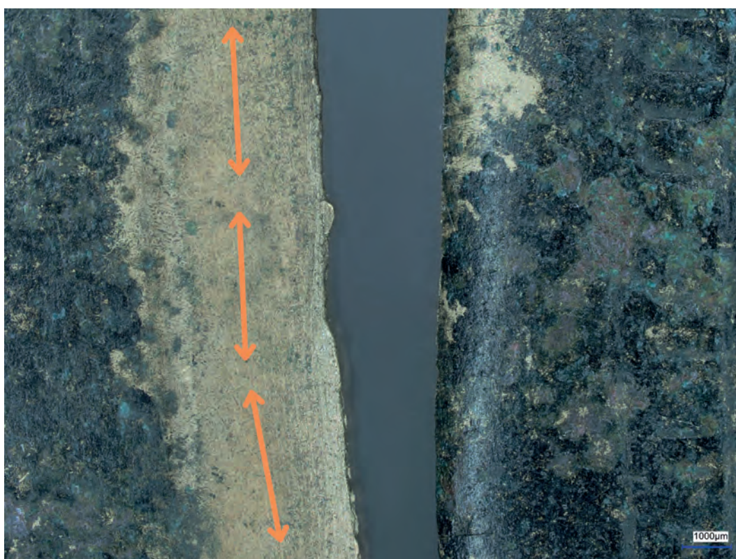
Ryc. 9. Napierśnik kat. 6 – równoległe, podłużne zarysowania na styku dwóch elementów Fig. 9. Collar cat. 6 – parallel, longitudinal striations at the contact between two elements
