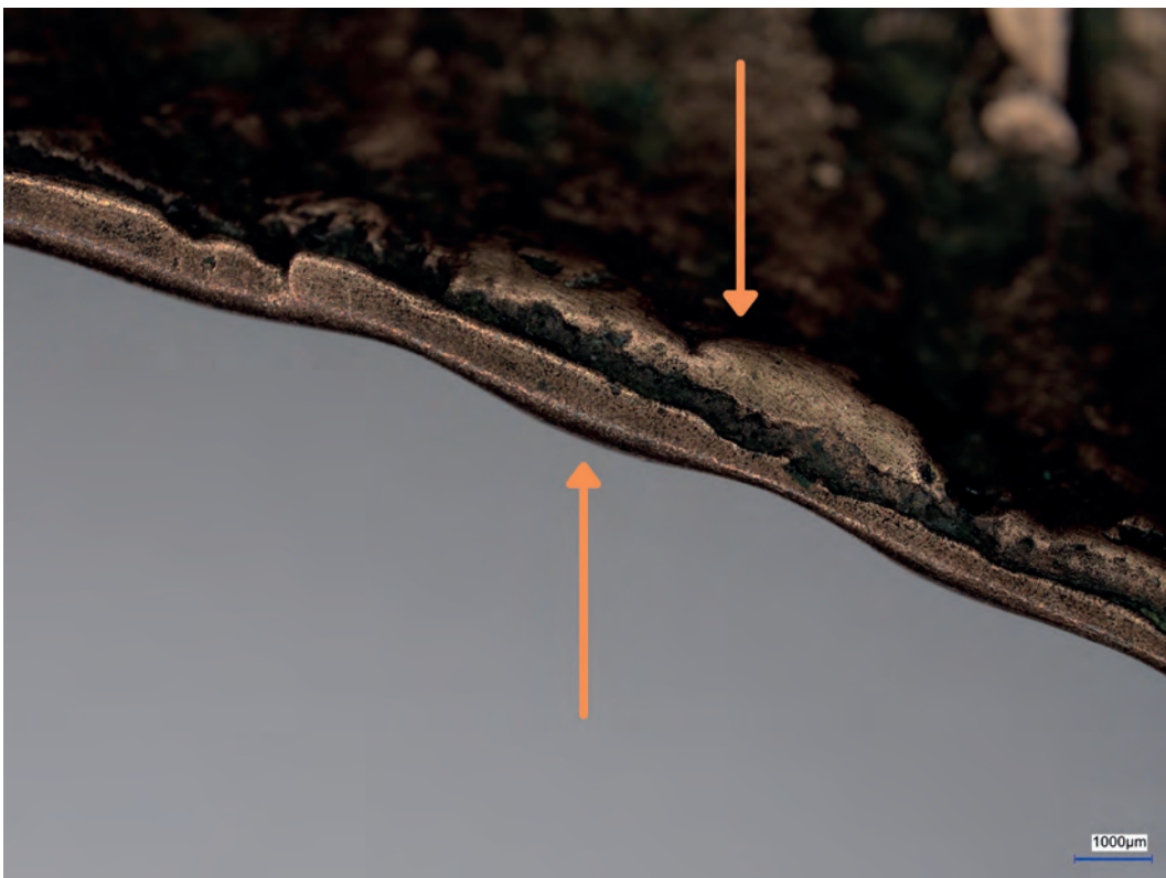
Ryc. 11. Napierśnik kat. 12 – związane z produkcją (szlifowanie) zarysowania wewnątrz oraz zagładzenia na krawędzi przedmiotu, które mogły powstać w wyniku kontaktu z tkaniną Fig. 11. Collar cat. 12 – technological (grinding) striations inside and dulling on the edges, possibly caused by contact with fabric
